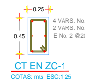
DETALLE DE CIMENTACION DEL ASTA COTAS: mts ESC: 1:25
